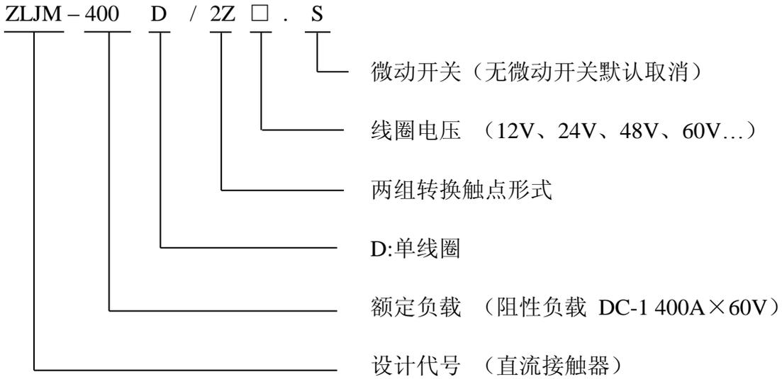
例: ZLJM-400D / 2Z48. S; 表示: 两组转换直流接触器, DC-1 负载下额定电流为 400A, 线圈电压 DC48V , 带辅助回路微动开关。
